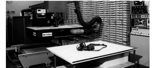
Erste CNC-gesteuerte CO 2 -Lasereinrichtung für die Stanzformenfertigung in Europa.
