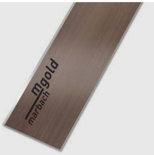
Die Spezial-Schneidlinie mgold besticht durch ihre Härte. Sie besitzt eine 42°-Schneide. Dadurch ist sie sehr scharf und bestens als Ritzlinie geeignet. Sie punktet bei hohen Auflagen und sehr kritischen Materialien. Wie dem Stanzen von metallisiertem Karton oder dünnen Metallfolien.
