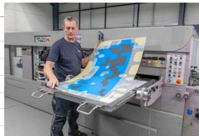
Die Stanzmaschine unterliegt abnutzungsbedingten Toleranzen. Deshalb war es bislang notwendig, bei der Einrichtung eines Auftrages abgenutzte Zonen durch Zurichtepapier aufzufüllen. Dieser Aufwand entstand bei jedem einzelnen Auftrag. Mit dem digitalen Zonenausgleich ist der Ablauf deutlich effizienter. Denn diese Zonenzurichtung muss pro Maschine nur einmal durchgeführt werden. Und hält dann gleich für mehrere Monate.
