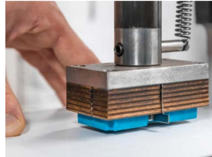
Um schnell und einfach Teststreifen für den Stanzzrilltester herzustellen, ist es sinnvoll, unsere Kniehebelpresse einzusetzen. Damit können Kartonstreifen der Größe 60x25mm geschnitten werden. Die Kniehebelpresse und die passenden Werkzeuge sind mit einer visuellen Hilfe ausgestattet, die die korrekte Position für die Ausstanzung der Kartonstreifen schnell und sehr präzise sicherstellt.
