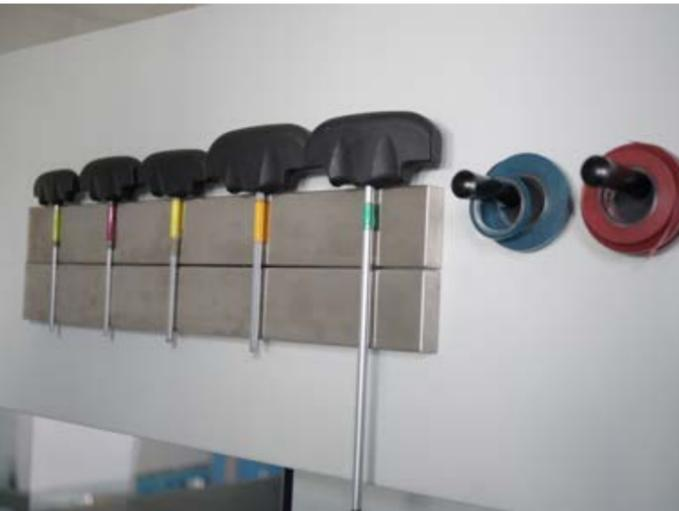
Das Marbach Tool-Organizer-Set 1 schafft Ordnung an Ihrer Stanzmaschine. Es besteht aus speziellen magnetischen Leisten, die mit Schraubenschlüsseln sowie magnetischen Haken für Zurichtebänder ausgestattet werden. Für den sofortigen Zugriff direkt an der Stanzmaschine. Dadurch reduzieren Sie Laufwege und Suchzeiten.
