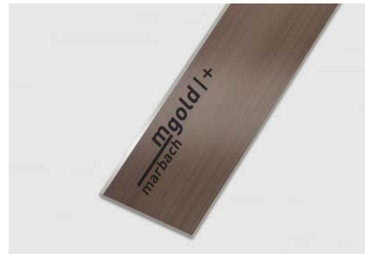
Wie ihr kleiner Bruder mgold besitzt diese Schneidlinie eine 42°-Schneide. Dadurch und durch ihre spezielle Beschichtung ist sie nicht nur sehr scharf, sondern auch sehr hart und damit für höchste Anforderungen geeignet. Sie ist äußerst resistent gegen Abrasion und wird deshalb eingesetzt, wenn höchste Standzeiten beim Stanzen kritischer Materialien erreicht werden sollen.
