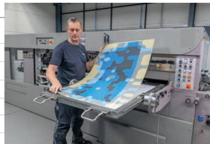
La machine de découpe est soumise à des irrégularités de niveau dues à l'usure. C'est pourquoi jusqu'à présent, il était nécessaire de faire une mise de zone lors du calage de chaque commande. Avec l'ajustement apporté par la compensation digitale de zone DZL, le processus est nettement plus efficace. En effet, cette compensation de zone au niveau de la platine est à faire une fois par machine. Et cela dure en moyenne 12 mois ou plus.
