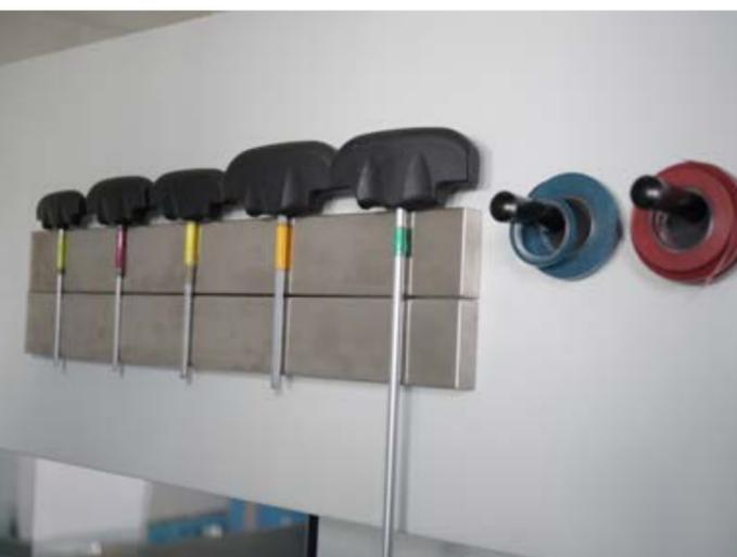
Le Tool-Organizer-Set 1 de Marbach met de l'ordre à l'emplacement de la machine de découpe. Il se compose de barres magnétiques spéciales qui sont équipées de clés et de crochets magnétiques pour les bandes de mise. Pour un accès immédiat et direct à l'emplacement de votre machine à découper. Vous réduisez ainsi les déplacements et les temps de recherche.
