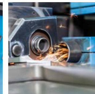
Stacjonarna szlifierka CNC z punktem mocowania.
