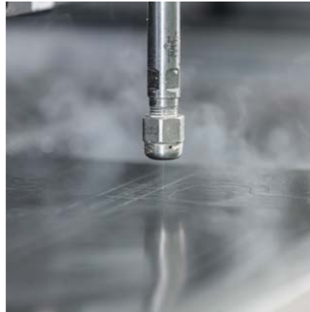
Cięcie strumieniem wody za pomocą mjet.
