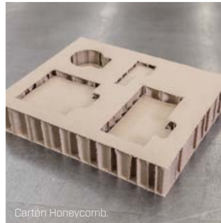
Herramienta especial Cartón de nido de abejas. Troquelado por ambos lados.
