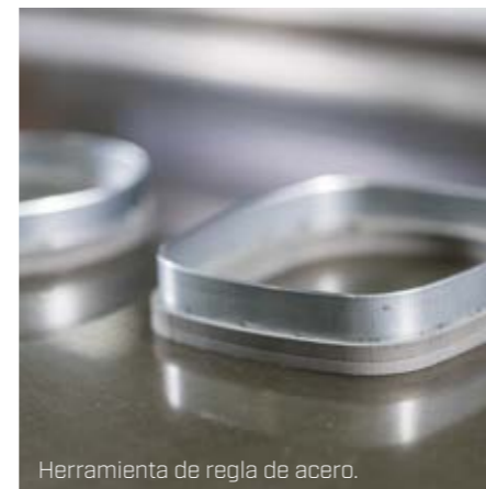
Herramienta especial Cartón de nido de abejas. Troquelado por ambos lados.
