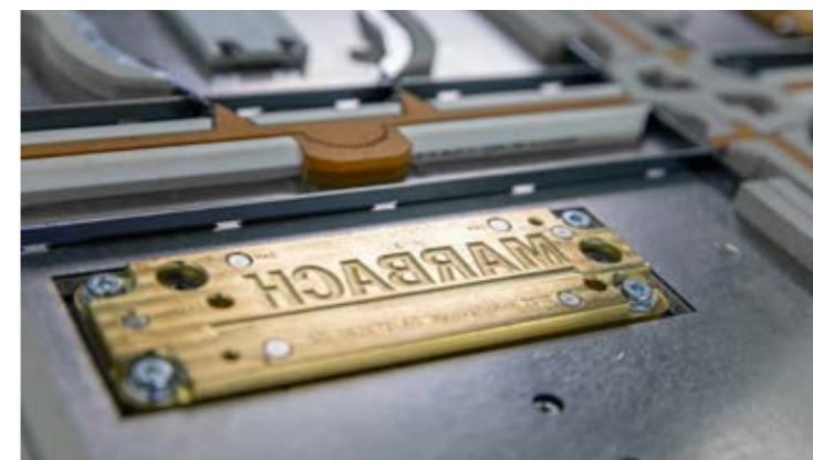
Troquelado y realzado en una solo paso.
