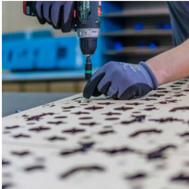
Fabricación de un herramental de desbarbe.
