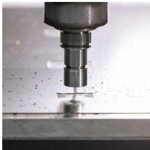
Fresado de una plancha de acero con mgrav|2.
