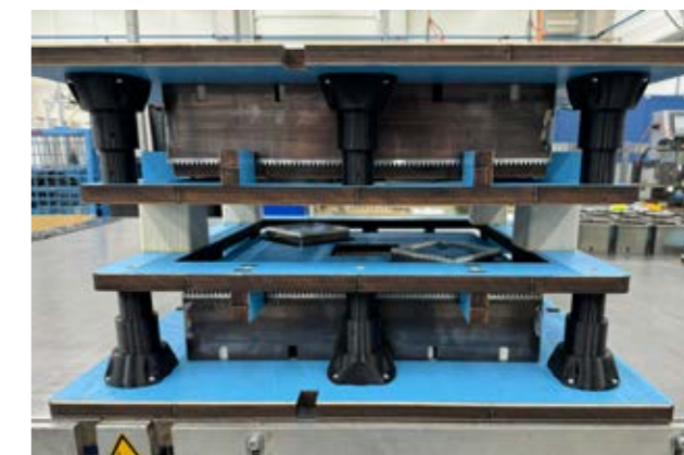
Herramienta especial Cartón Honeycomb. Troquelado por ambos lados.
