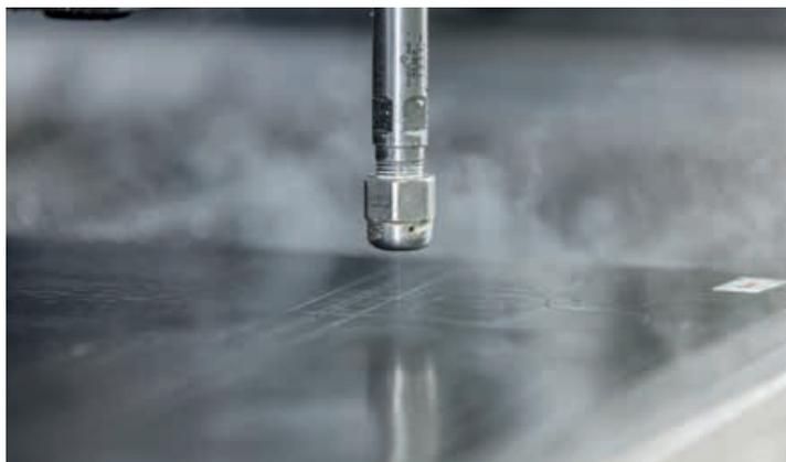
Wasserstrahlschneiden mit der mjet.
