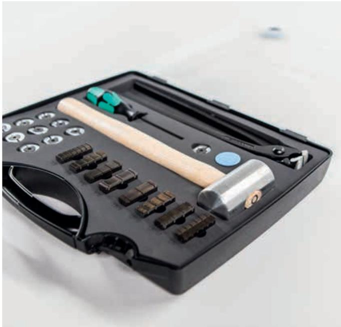
Der Haltepunktwechselsystem-Koffer für Wellpappe-Anwendungen. Tauschen Sie Haltepunkte nach Bedarf.
