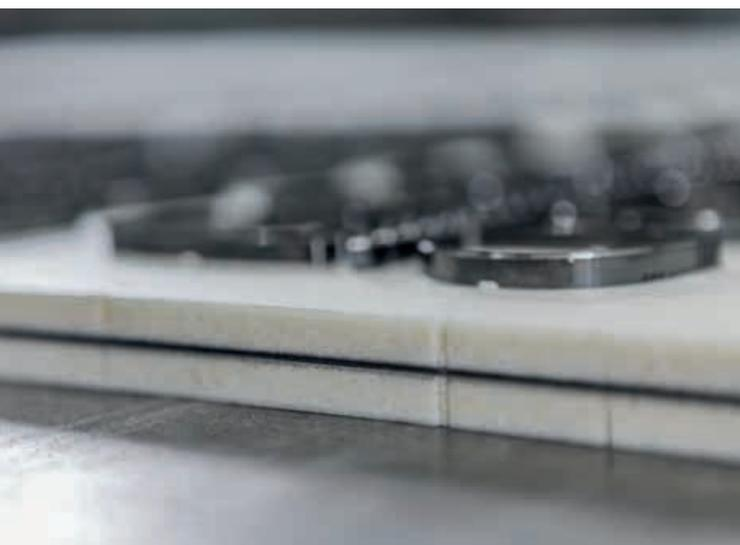
duramar-Trägerplatten sind eine Verbindung aus faserverstärktem Kunststoff und Stahl. Dadurch sind sie nicht hygroskopisch. Sie zeichnen sich somit durch hohe Maßstabilität und extrem lange Lebensdauer aus. Es gibt sie in den Ausführungen eco, plus oder performance. duramar-Stanzformen bestehen durch häufige Wiederbemesse- rung und enorme Passergenauigkeit. Selbst bei großen Maschinenformaten. Für tolle Rillergebnisse.
