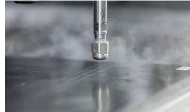
Corte por chorro de agua con el sistema mjet.
